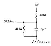
Figure 2. AC Test Load (for tolz, tclz, tohz, tchz, tow & twz)
