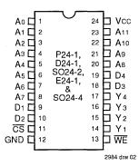
DIP/SOIC/SOJ/CERPACK TOP VIEW
