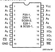
DIP/SOIC/SOJ/CERPACK **TOP VIEW**
