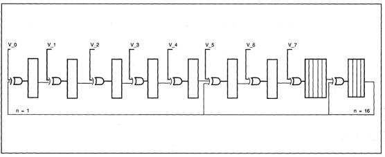
FIGURE B-1. LINEAR FEEDBACK SHIFT REGISTER
