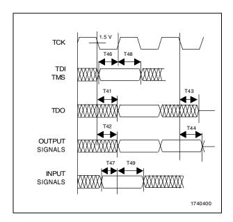
Figure 4-7. JTAG Test Timings
