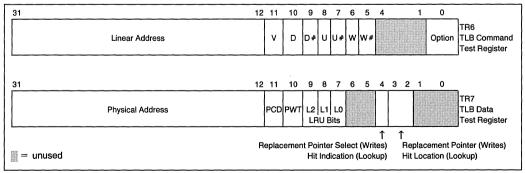
Figure 8.7. TLB Test Registers
