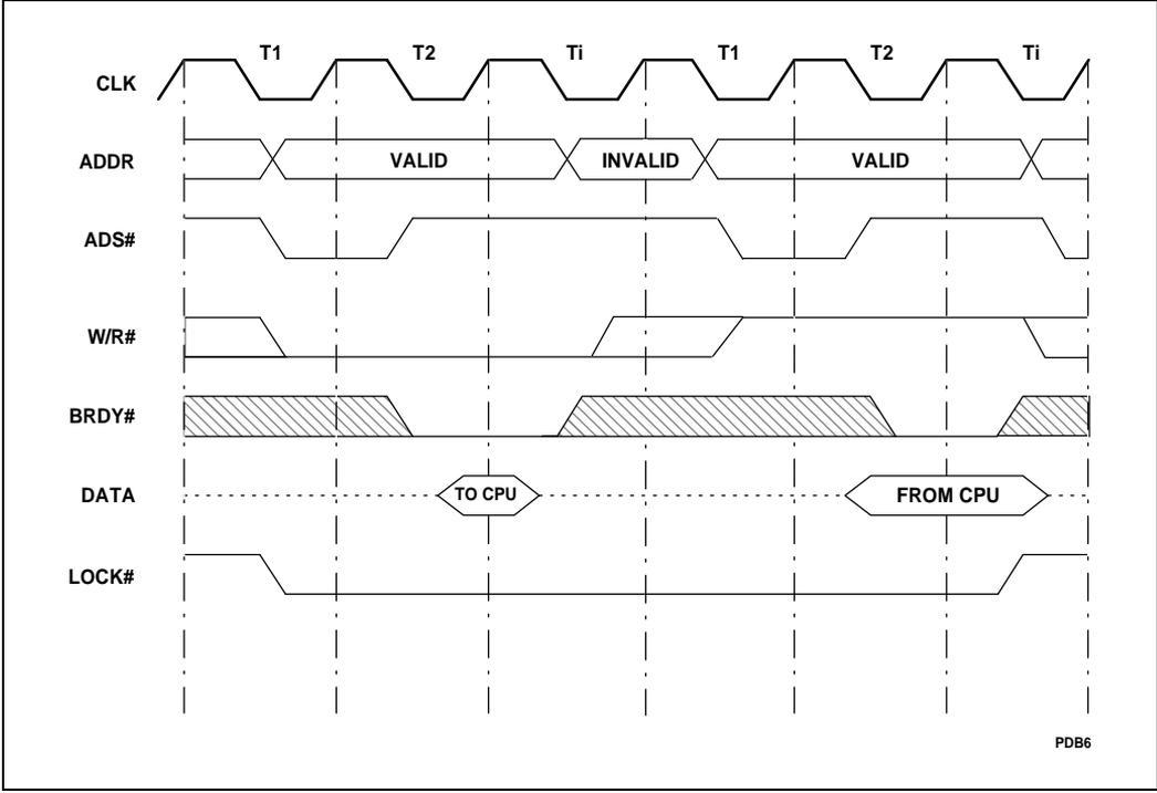
Figure 6-11. LOCK# Timing
