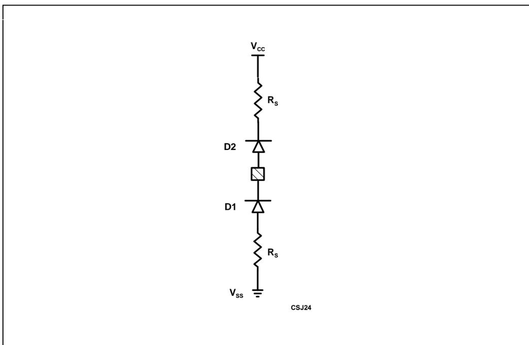
**Figure 8-3. Input Diode Model**
