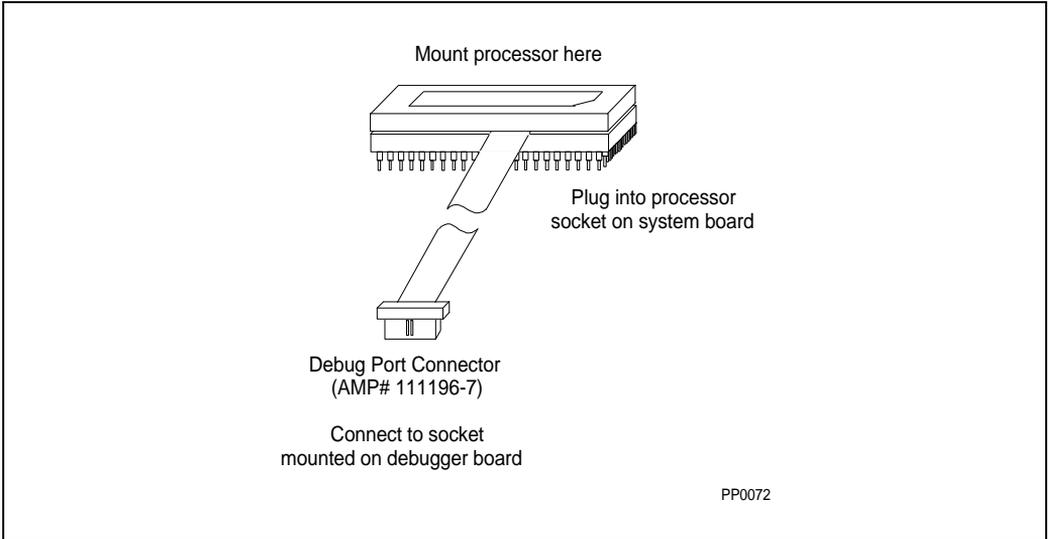
**Figure 31-8. Uni-Processor Debug**
