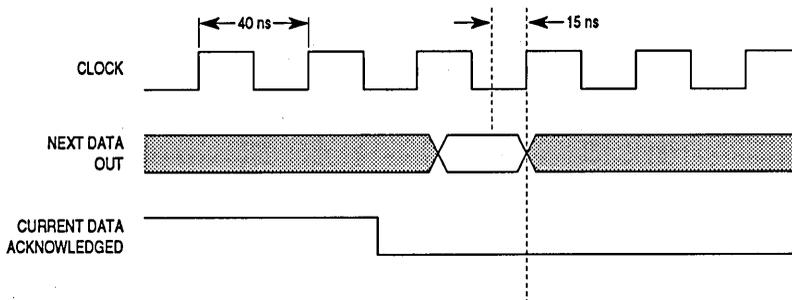
**Figure 3-6. Simple Burst Bus Access**
