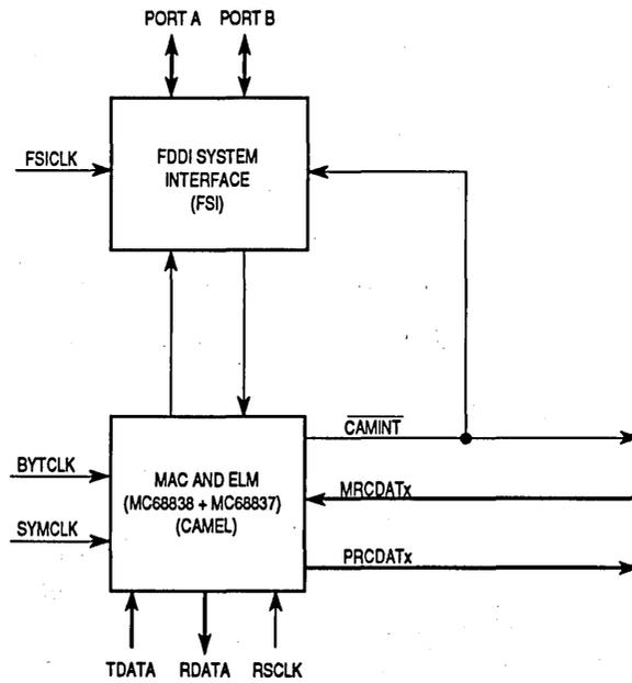
**Figure 1-2. IFDDI Block Diagram**
